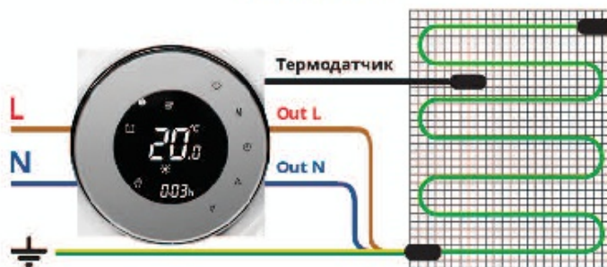
Мал. 3. Схема підключення нагрівального мату ThermoGreen™
